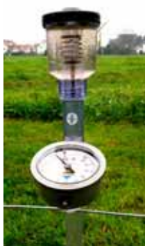
Gerät zur Bestimmung der Bodenfeuchte (Tensiometer)
