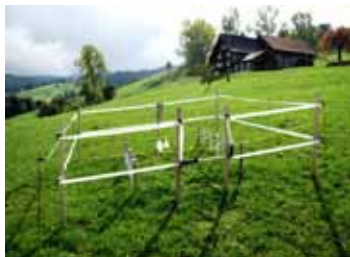
Messstation Ebnat-Kappel (SG) zur Bestimmung der Bodenfeuchte
